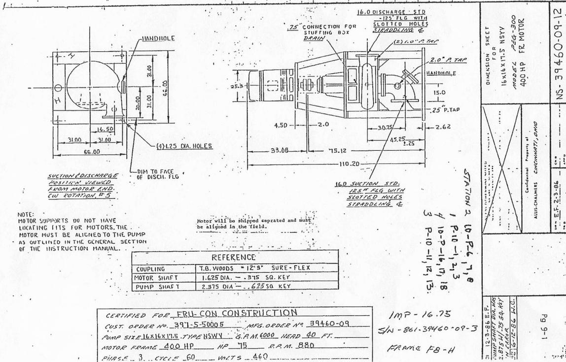
SUCTION & DISCHARGE POSITION VIEWED FROM MOTOR END. CW ROTATION 4-5. DIM TO FACE OF DISCH. FLG.
